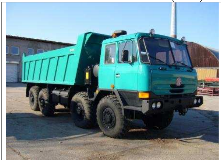
Obr. č. 2 Uvažované vozidlo: Tatra 815 6x6 (s užitným zatížením 16t. Výkon motoru 300kW)
